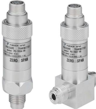
PC-700シリーズは当社独自の電磁波シールド構造とEMIフィルター及び貫通コンデンサーの採用により強力な高周波ノイズも寄せ付けず、業界トップレベルの耐ノイズ性能を誇ります。出力は4～20mA、または0～5Vの電流出力となっていますので、特に電気的ノイズの多い環境での長距離電送に適しております。また、優れた温度特性を有する高精度圧力センサーです。
