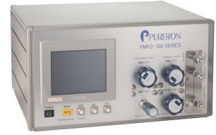
分子フローコントローラーは、標準コンダクタンスエレメント(別売)を用いて、真空容器内に既 知の流量の各種気体を導入することができる装置です。
